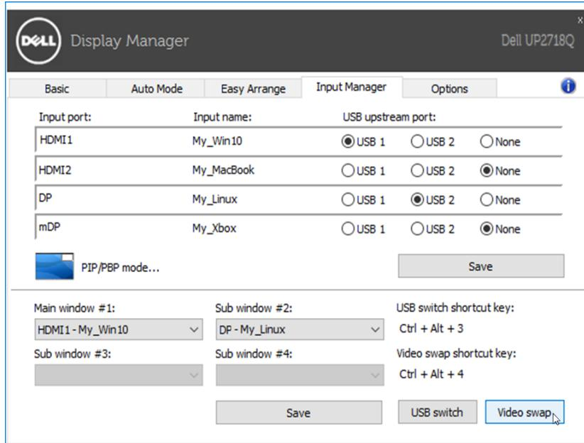
您可指派含視訊輸入的 USB 上游連接埠。視訊顯示於顯示器時代表指派的 USB 上游連接埠已連接至電腦。
